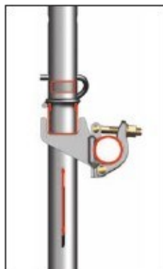
Joonis 52: Seinakinniti muhvi läbilõige
