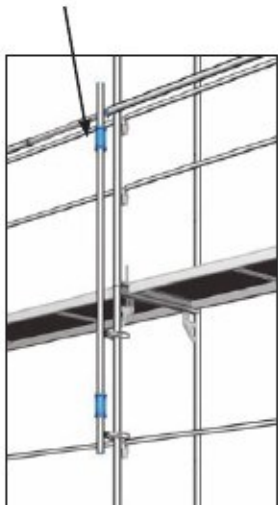
Joonised 21 ja 22: Kaitsepiirde posti ühendus Speedy tellinguraamiga
