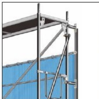
Joonis 130: näide Kederi presentisüsteemi monteerimise kohta
