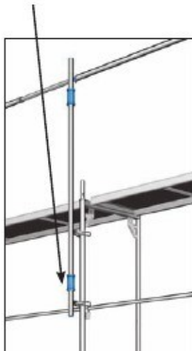
Joonised 21 ja 22: Kaitsepiirde posti ühendus Speedy tellinguraamiga
