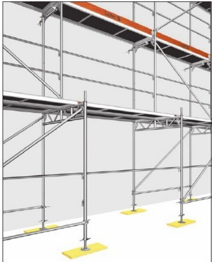
Joonis 105: Tunneliraamide paigaldamine
